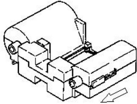
◆使用済みのボビンからインクリボンを剥がし巻き取られているインクリボンはボビンごと廃棄します。
