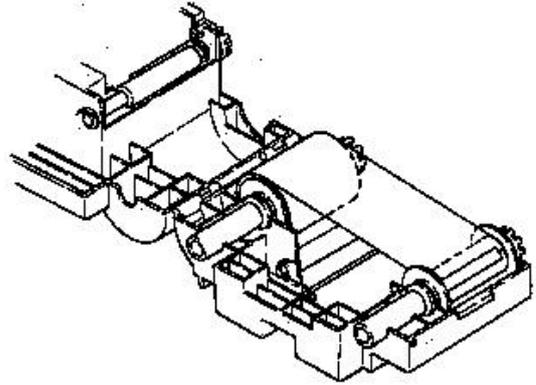
◆新しいインクリボンの端部を剥がし、巻き取り側のボビンに貼り付けます。
