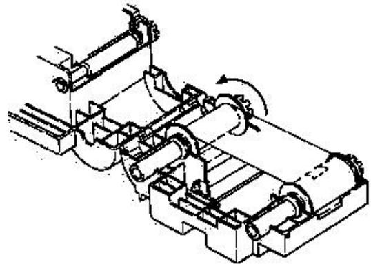
◆その際、インクリボンの中央とボビンの中央が合うように貼り付けます。
