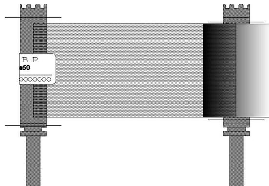
◆リボンカートリッジを閉じてロックし、巻き取り側のボビンを矢印の方向に2～3周回して、プリンターにセットします。
